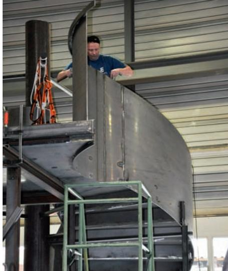
Die Schweissarbeiten im Werk der Lenzlinger Söhne AG erfolgten nach **genauem Schweissfolgeplan**. Les travaux de soudure dans l'atelier de Lenzlinger Fils SA ont été effectués selon un plan de soudage précis.
